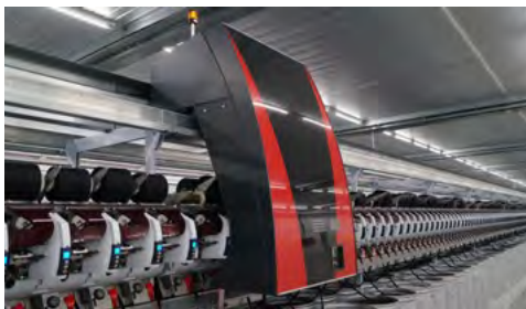
Rotorspinnmaschine Autocoro 11 für die Herstellung von Garnen aus Recyclingfasern © 2023 Saurer
