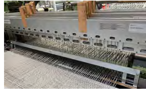
Breitenvariables, elastomerbasiertes Webblatt © ITM
