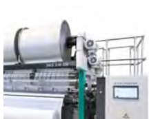
Hochleistungs-Kettenwirkmaschine mit energieeffizientem Direktantrieb © 2023 KARL MAYER
