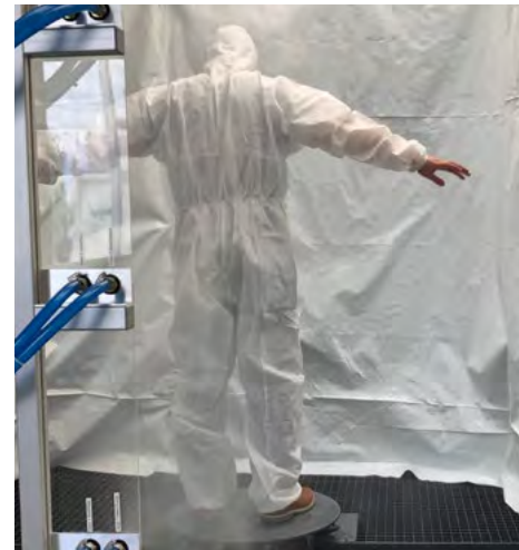
Ein Chemikalienschutzanzug schützt die Person, die ihn trägt, vor Chemikalien in gasförmigem, flüssigem und/oder festem Zustand. Sie werden in 6 Typen mit unterschiedlichen Schutzstufen eingeteilt, von gasdicht bis eingeschränkt flüssigkeitsdicht © Hohenstein
