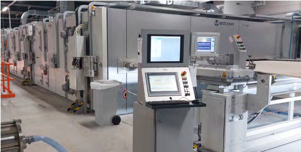
Elektrisch beheizter DUO-THERM Ofen zur Vliesstoffausrüstung © 2023 Brückner
