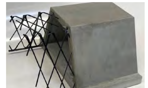
Einbetonierter textiler Netzgitterträger © ITM/TU Dresden
