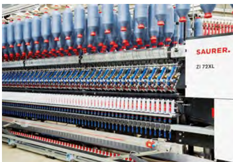
Die Kompaktspinnmaschine ZI 72XL verarbeitet recyceltes Garn © 2023 Saurer
