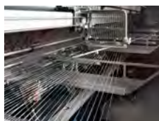
Schußträger an einer Kettenwirkmaschine mit Schußeintrag © 2023 KARL MAYER
