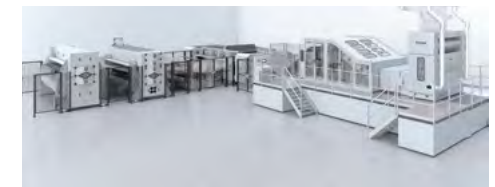
Eine erste T-SUPREMA Vernadelungsanlage © 2023 Trützschler
