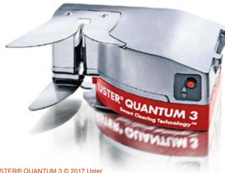
El USTER® QUANTUM 3 es un sistema de despejado y control de hilo para máquinas de bobinado que consta de la Unidad Central de Compensación 6 (CCU6) con una unidad de control por devanadora donde todos los ajustes y comprobación de funcionamiento de cada posición se realizan desde la Unidad Central de Compensación, cabezas inteligentes de medición de compensación (iMH) para cada posición de bobinado y una interfaz para las posiciones de bobinado y los cables de conexión.
