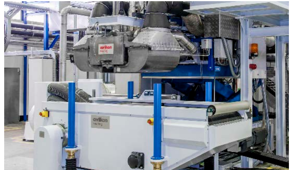
La mesa multifuncional Oerlikon Neumag para la formación de sistemas de soplado en fusión con una huella considerablemente reducida y una longitud de cable reducida que reduce los costos de mantenimiento. (c) 2017 Oerlikon
