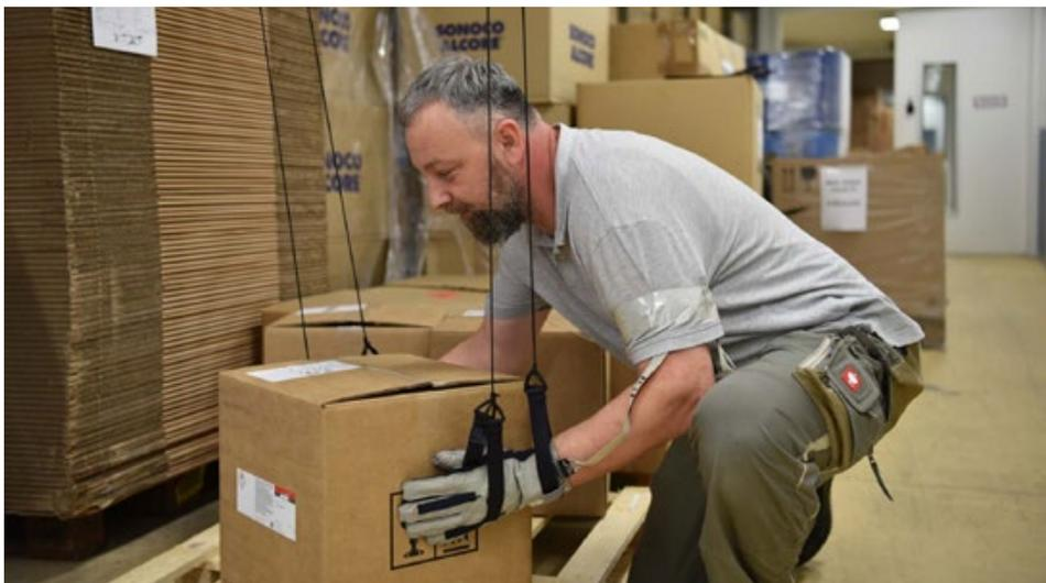
Mover cargas pesadas sin esfuerzo físico usando SensHand. Foto: DITF
