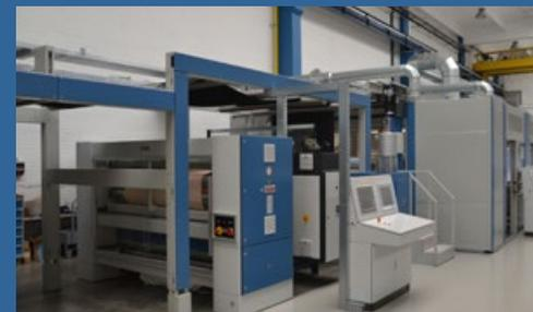
产业用纺织品涂装生产线（右）和针织物拉幅定型机
