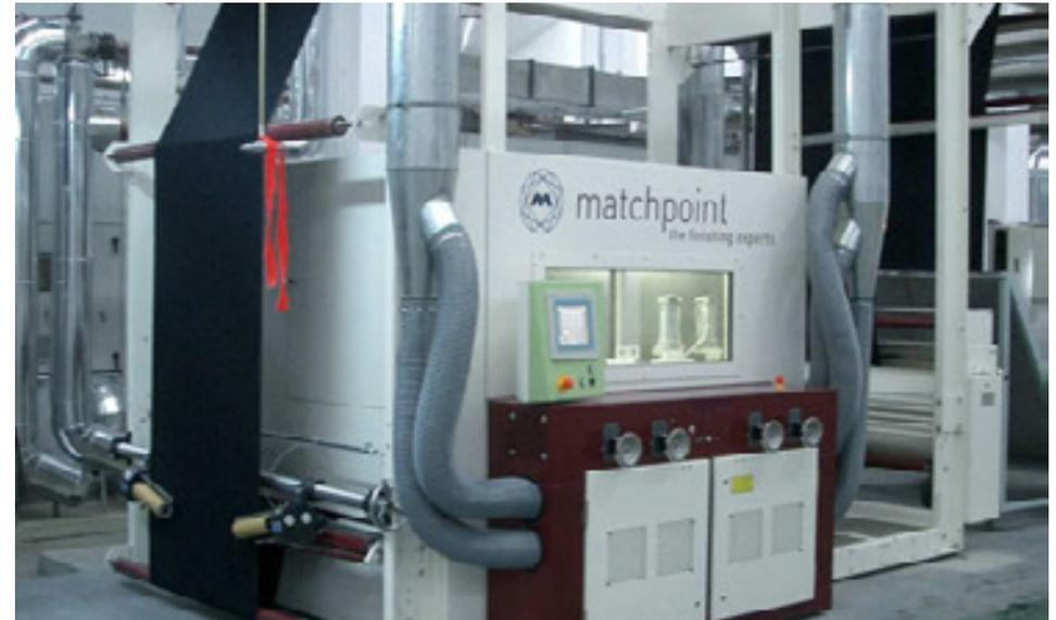
El uso de la tecnología diamondpeach en la máquina de esmerilado diamondTec
