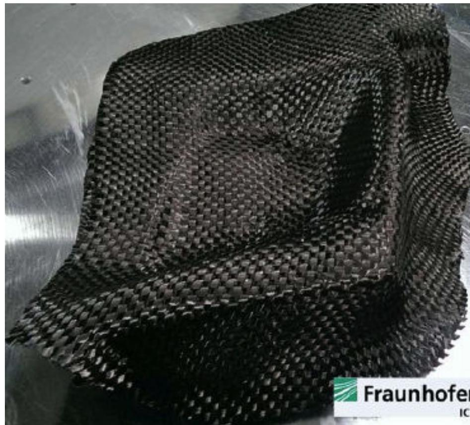
Pic: (4) La preforma tridimensional de una cabeza de lámpara, terminó usando un tejido de carbono de 12K.
