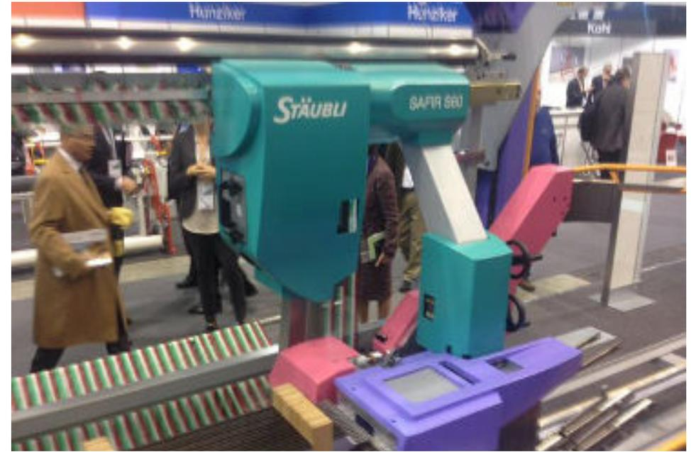
Stäubli con la nueva máquina de remeteo SAFIRS60 con sensores ópticos para el control activo del urdimbre.
