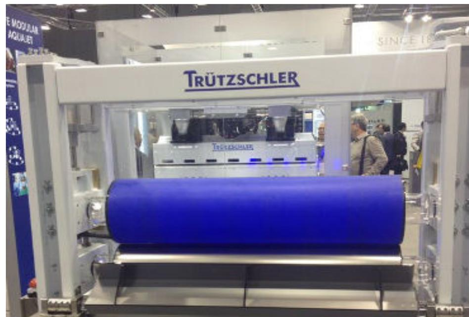
Trützschler Nonwovens presentó un nuevo líquido foulard con una ventaja del 50% en la velocidad realizado por una superficie especial de los rodillos.
